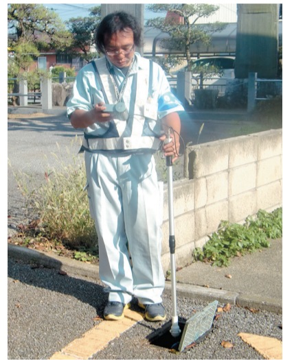
▲漏水調査をしている様子
