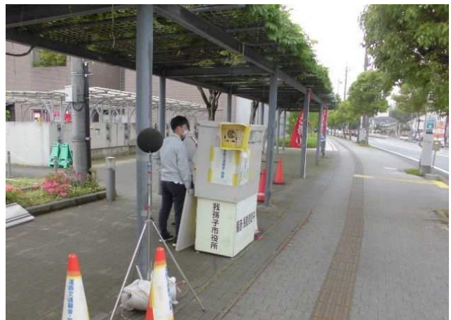
騒音測定の様子
